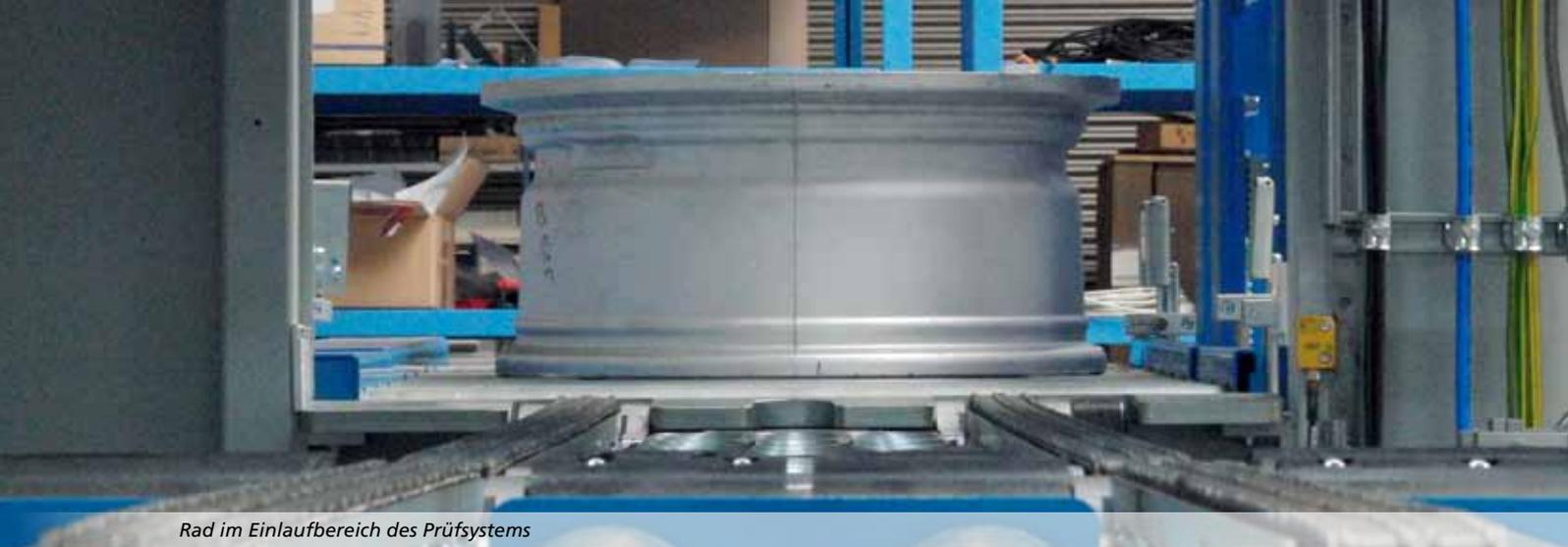
Rad im Einlaufbereich des Prüfsystems
