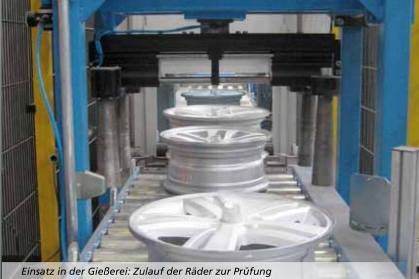
Einsatz in der Gießerei: Zulauf der Räder zur Prüfung
