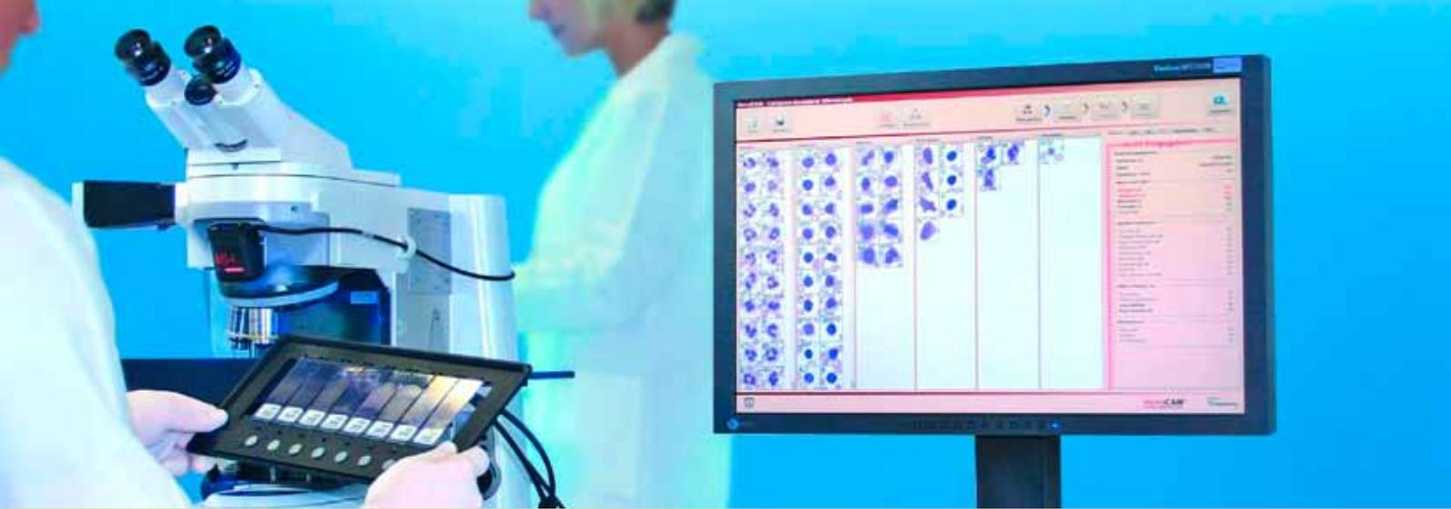
Abbildung 1: HemaCAM besteht aus einem vollautomatisierten Mikroskop mit angeschlossener Kamera, Rechner und grafischer Benutzeroberfläche und ermöglicht die automatisierte Analyse von Blutausstrichen und unterstützt die Klassifikation der weißen Blutkörperchen
