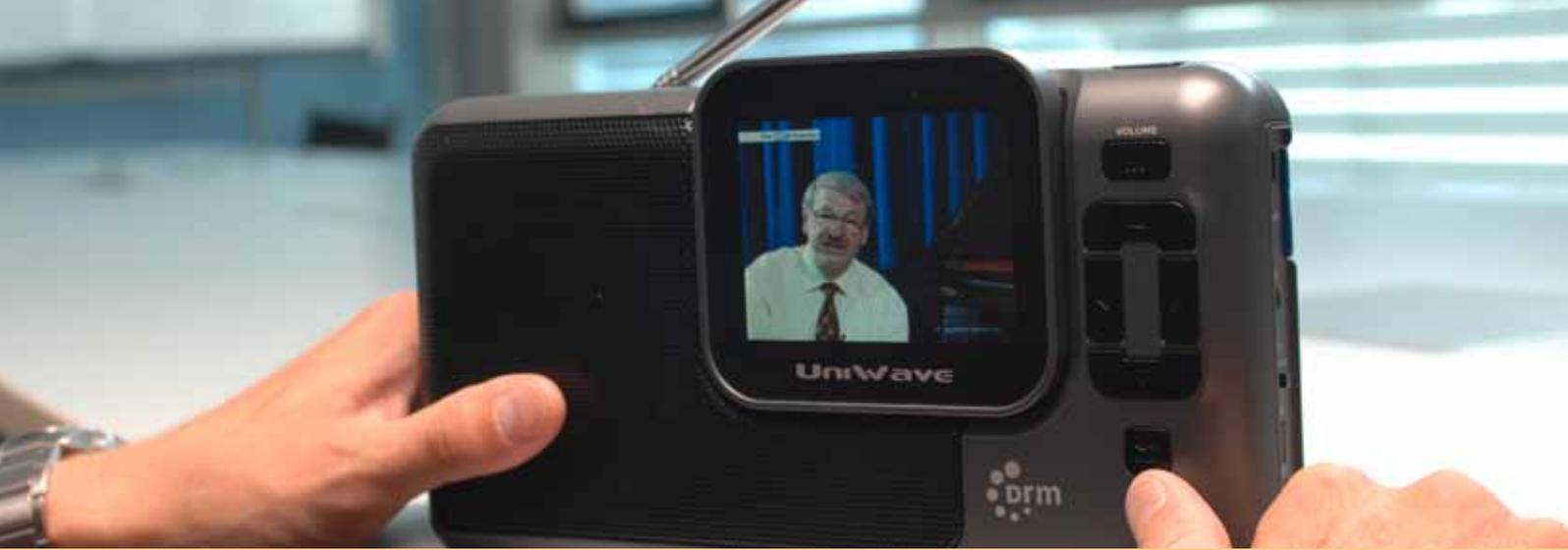
Abbildung 1: Diveemo-basierte Videosendung auf einem UniWave DRM-Empfänger
