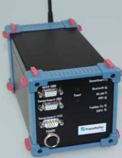
Abbildung 1: Entwicklungplattform zur nahtlosen Ortung mit GNSS, WLAN und Inertialsensorik
