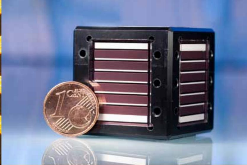
Abbildung 2: Der solarbetriebene Funk-Würfel lässt sich über den WakeUp-Receiver aktivieren und signalisiert die »gewürfelte« Augenzahl
